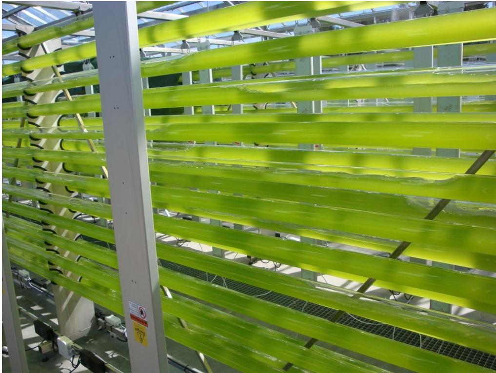
Figura 12: bio-reactor de microalgas
