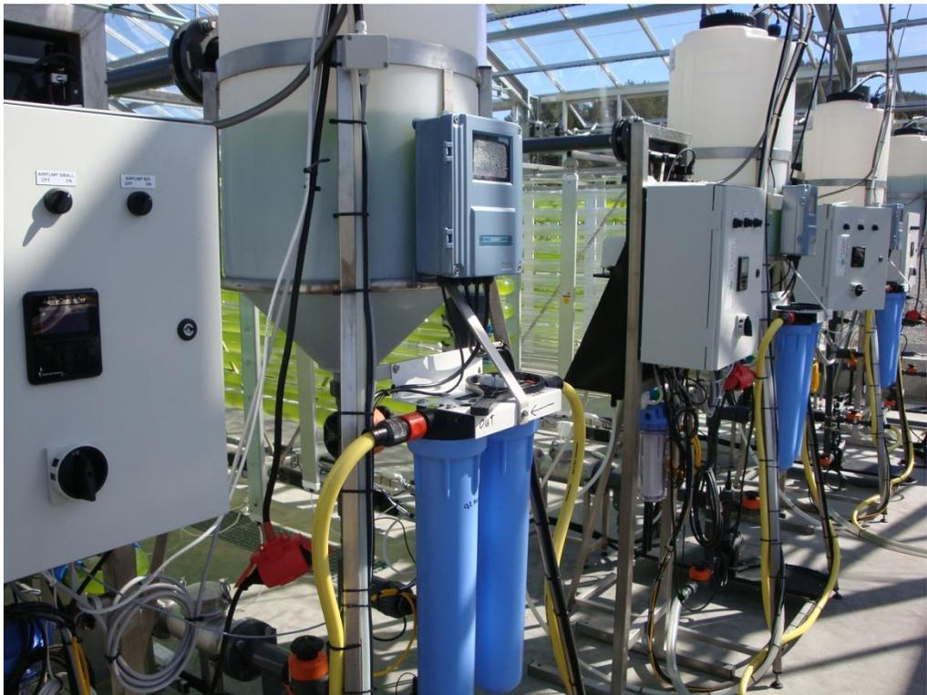
Figura 12: unidad de control del bio-reactor de microalgas
